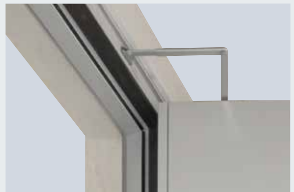
Bloková zárubeň 140 / 75 mm, třídičná, s těsnicí drážkou po 3 stranách
